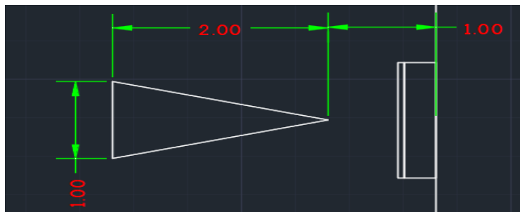
تصویر ۹. مشخصات گوه سقفی به ارتفاع نیم متر از سقف
